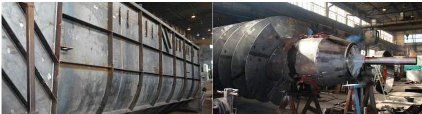
Fot. 4 Produkcja śruby Archimedes, od lewej: zabudowa samonośna, wirnik
